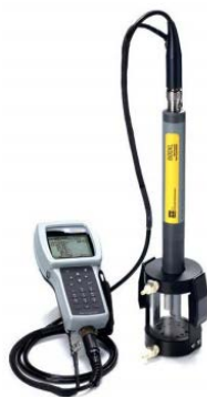
Figure 7. Sonde multi-paramètres de type YSI 600QS
